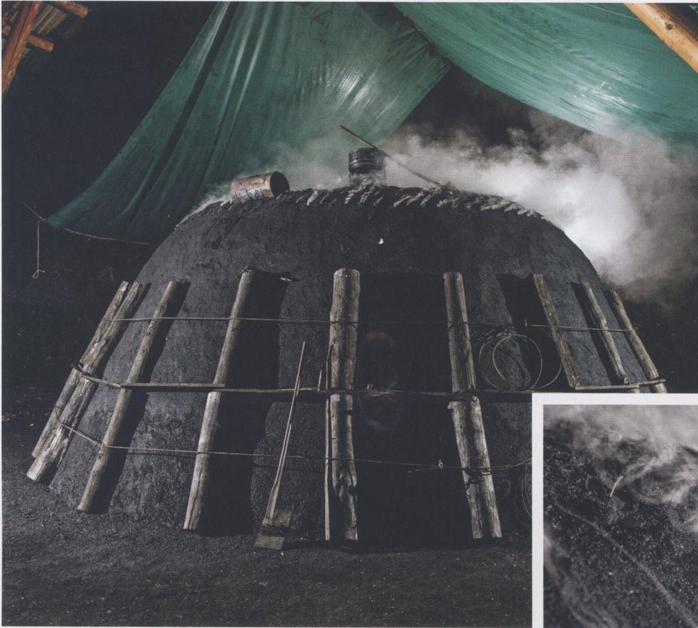
Durch die Luftlöcher reguliert Renggli die Sauerstoffzufuhr. Regelmässig hebt er den Eisendeckel, um nachzufeuern.
